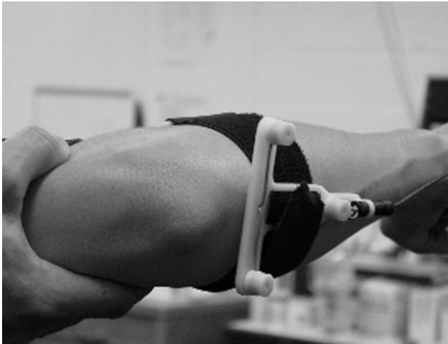
Abbildung 1: Bei dem verwendeten Messsystem (Fa. Zebris) sind drei Schallsender auf einer T-förmigen Plattform angeordnet. Die Schallsender werden bei den Probanden an der dorsalen Seite des proximalen Unterarmes in Höhe des Epikondylus humeri radialis fixiert.
