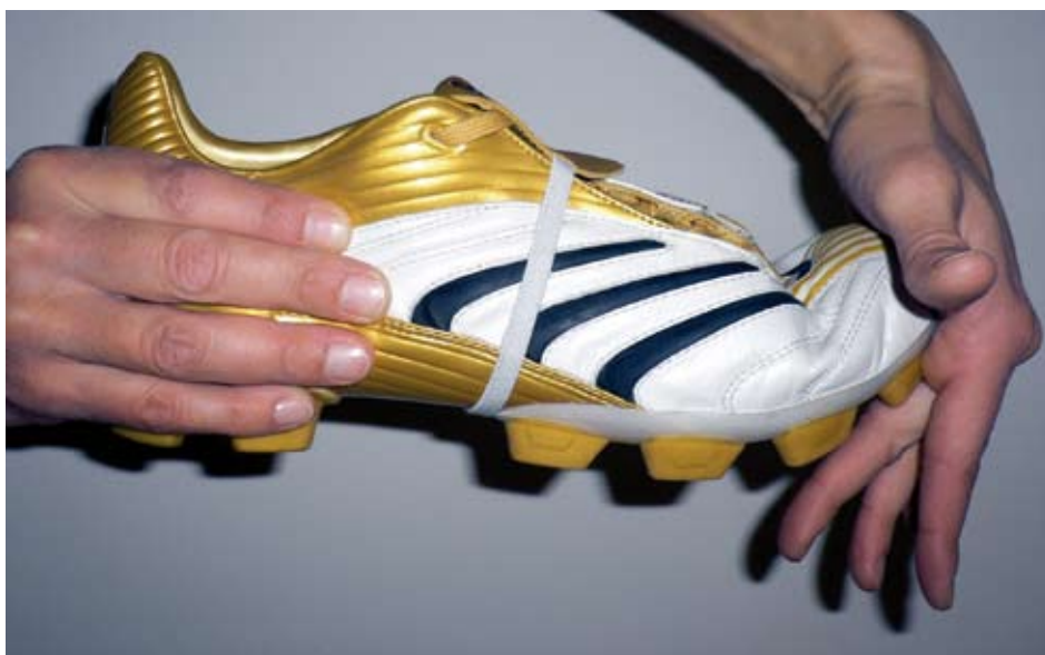
Abbildung 6: Regelhafte Flexionszone des Schuhs in Höhe der Zehengrundgelenke (Foto: M. Walther).
